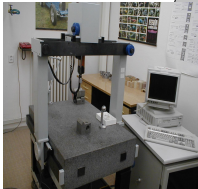
Souřadnicový měřicí stroj Somet Berox
