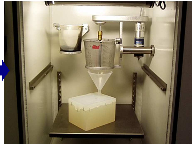
vakuování v komoře
