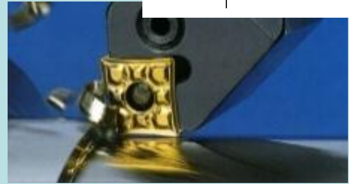
Příklady mechanického upnutí vyměnitelné břitové destičky (VBD) v tělese nástroje
