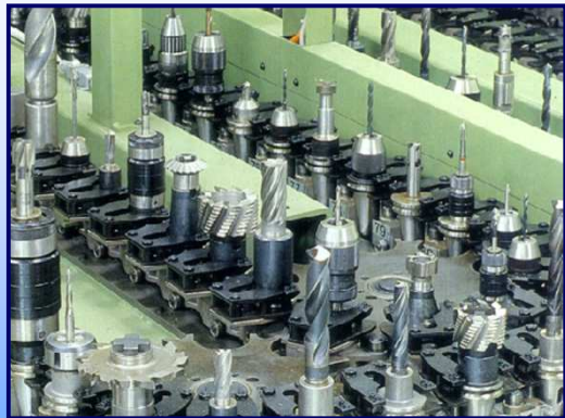
Zásobník nástrojů u CNC frézky
