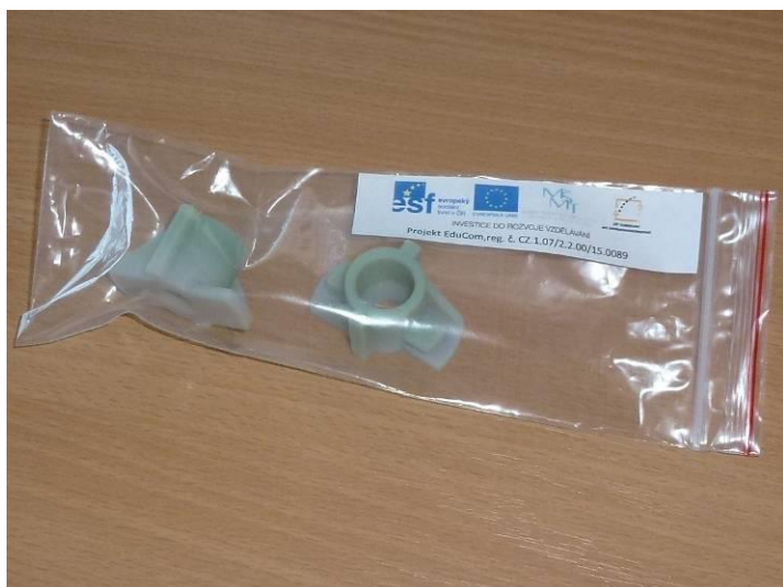
ukázka nedostatečného vyčištění stroje
