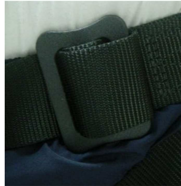
[OBR 8]-nesprávné zapojení
